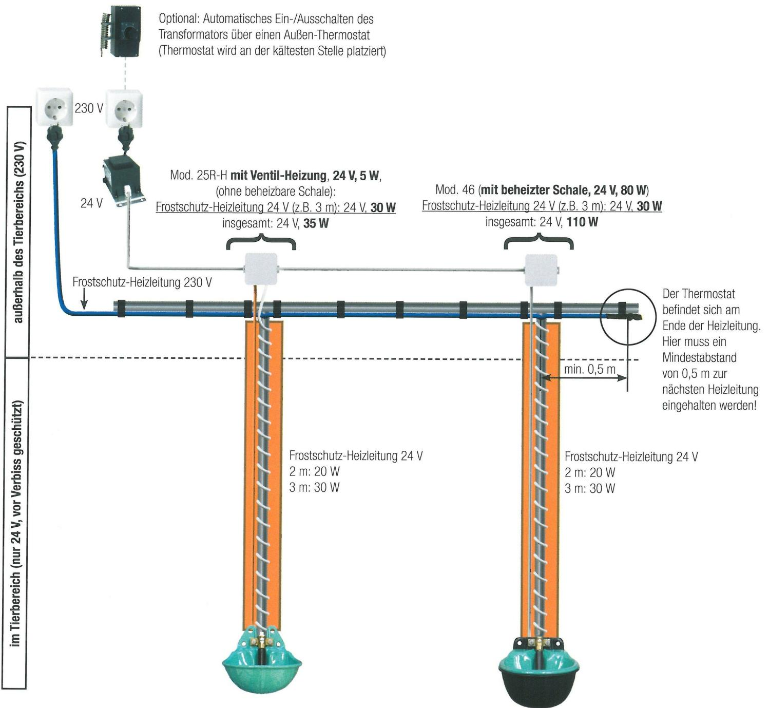
Aufbauschema mit optimierter Darstellung, ohne Isolation der Rohre. Für Details fragen Sie bitte Ihren Fachhändler.
